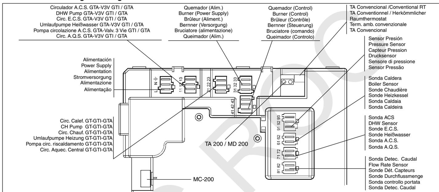
**Conexión conectores / Connection connectors / Connexions connecteurs
